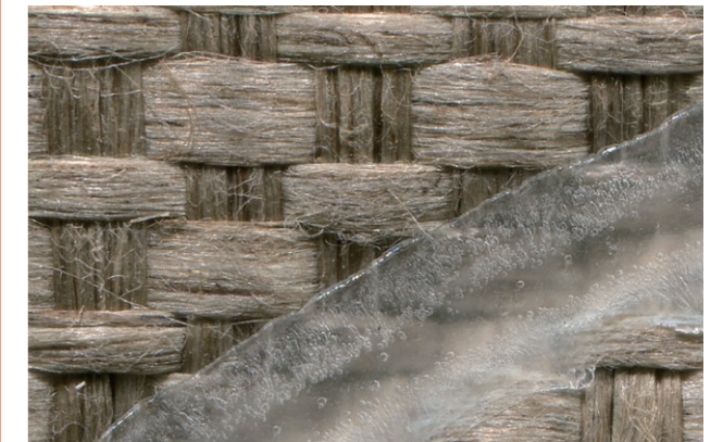
「PlyFlax」を補強する膜組織としての亜麻製羽布 Flax fabric used as a membrane for PlyFlax reinforcement Courtesy of Dr. Juri Kermik
