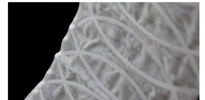
PLA樹脂と絹織物でつくった構造のプロトタイプ Prototype PLA + silk structures
