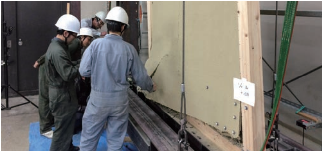
実験の様子。試験体を設置し、段階的に水平力を加えながら壊れ方を記録する The condition of the experiment subjected to horizontal force. Recording how mud walls deform and collapse.
